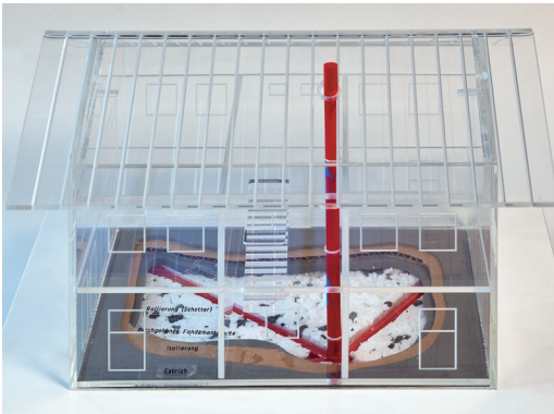
Modell: Unterboden-Absaugung, Abluft über Dach (Vollwandrohr mit einem Durchmesser von mindestens 12,5 cm)
